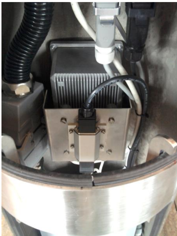
Figuur 76 De kentekencamera ingebouwd in de zuil
