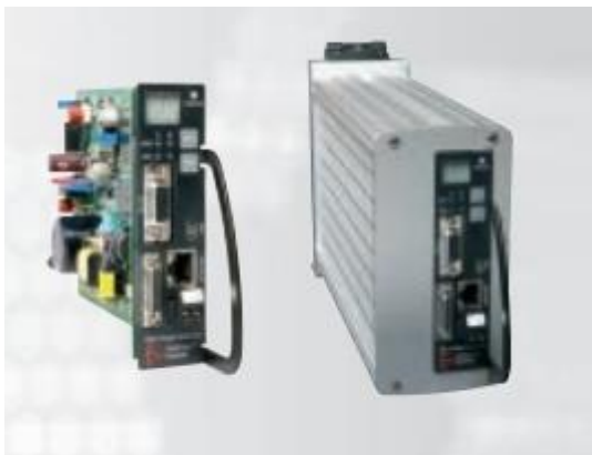
Figuur 52 De behuizing met de phase selector M752E
