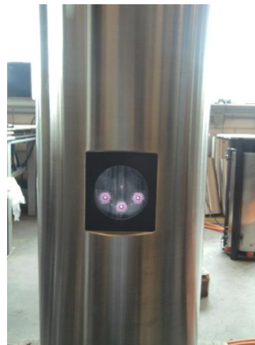
Figuur 22 De frontplaat van de kentekencamera
