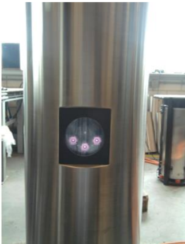
Figuur 78 Vooraanzicht van de kentekencamera in de zuil
