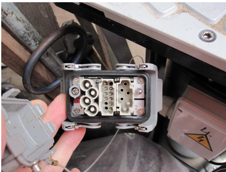
Figuur 62 De scheiding tussen de verschillende signalen in de connector
