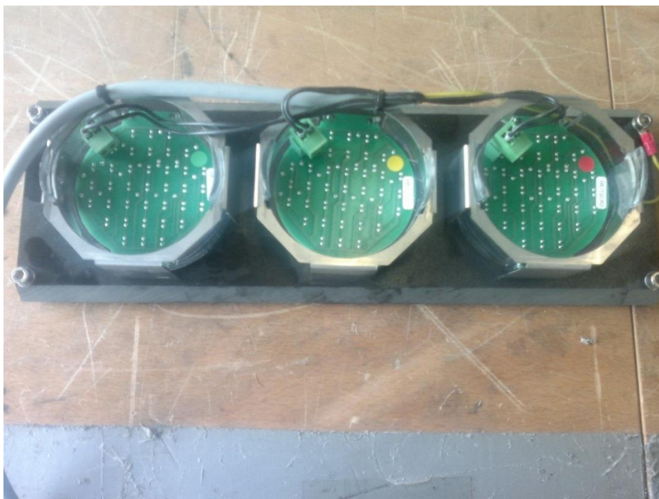
Figuur 27 Achteraanzicht huidige verkeers- en signaleringslantaarns
