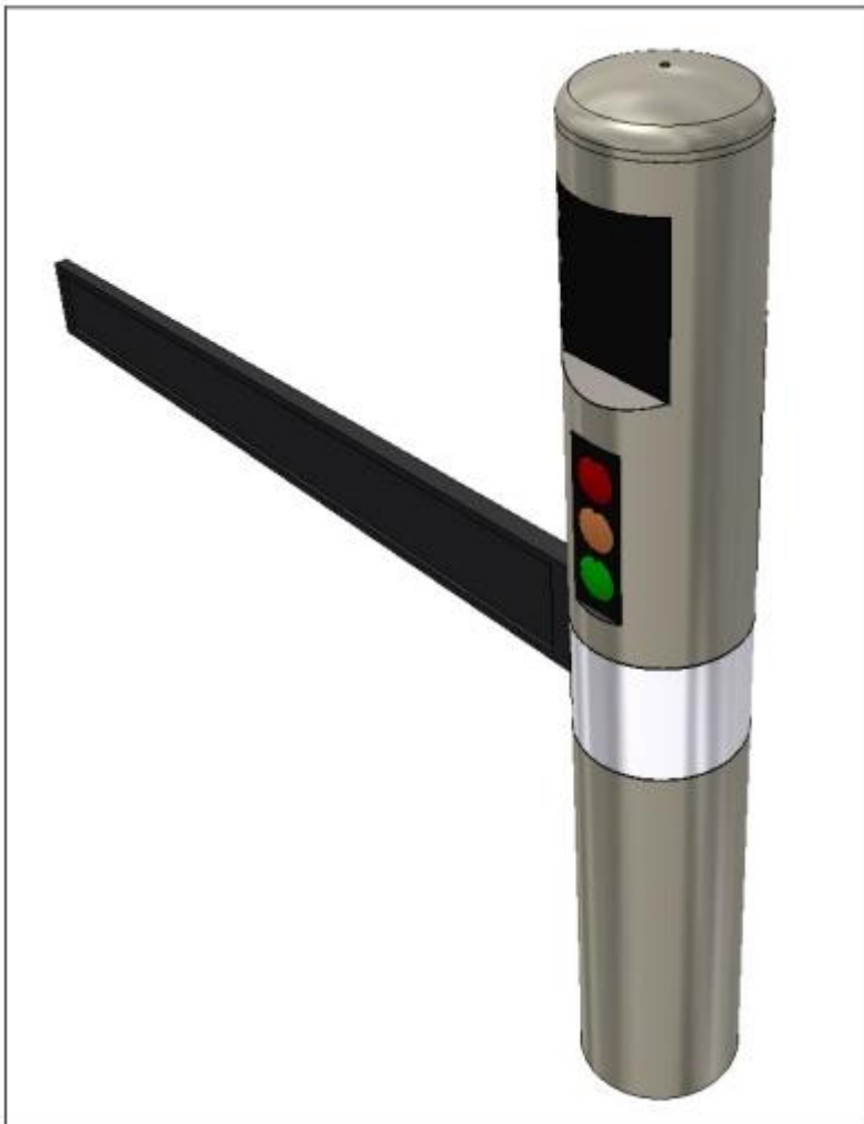
Figuur 63 Vooraanzicht van de nieuwe tramhekken
