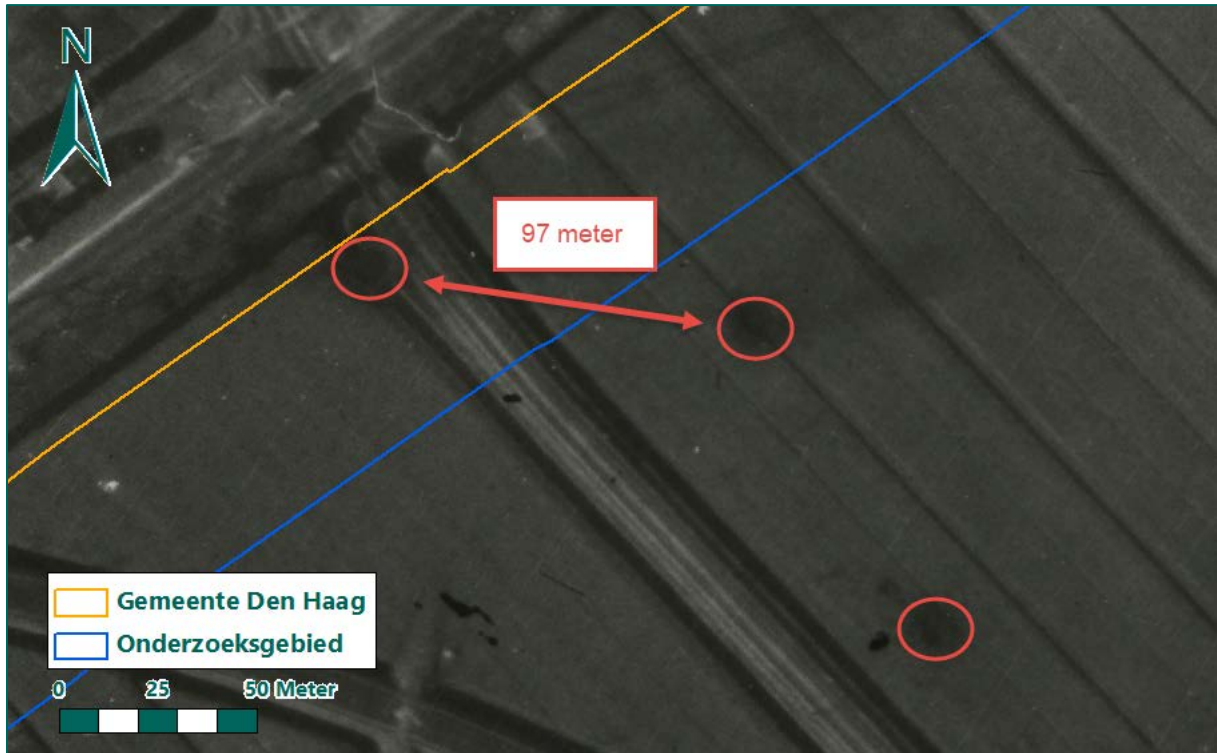
Figuur 218: Bomkraters (rood omlijnd) aan de rand van de gemeente Den Haag bij de spoorwegkruising op een luchtfoto d.d. 21 maart 1945. Daarnaast is de maximale afstand tussen twee bomkraters weergegeven. (bron: Kadaster).
