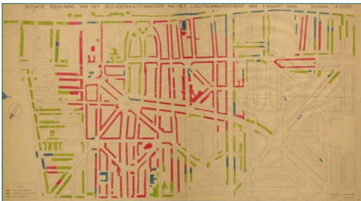
Figuur 191: Schadekaart naar aanleiding van het bombardement op 3 maart 1945. Met rood zijn de door brand beschadigde panden geaccentueerd, met blauw de onherstelbaar beschadigde panden en met groen de licht beschadigde panden. (bron: Haagse Beeldbank).
